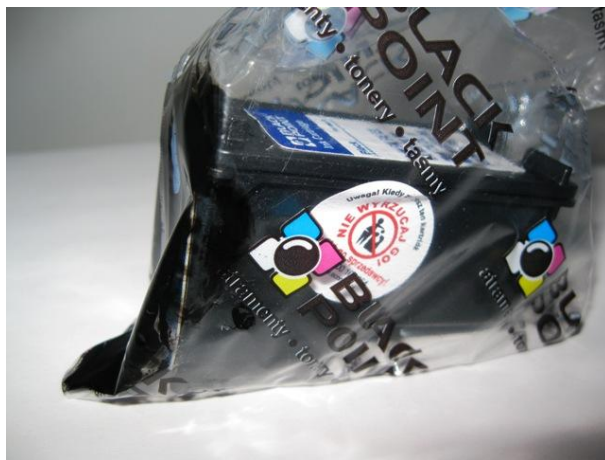
Wkład Black Point 339 (DOA) nr 1 — bezużyteczność w chwili dostawy spowodowana wyciekami atramentu do opakowania.
